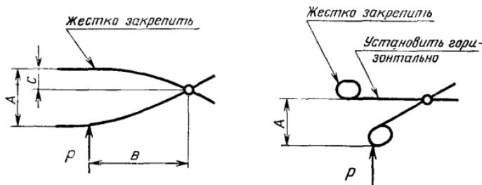
Размеры  $A$ ,  $B$  и  $C$  должны быть установлены в стандартах и технических условиях на инструменты конкретных видов. При этом угол раствора бранш должен быть  $(25—35)^\circ$ , а для инструментов, кремальера которых содержит более трех зубьев, не более  $45^\circ$ .
