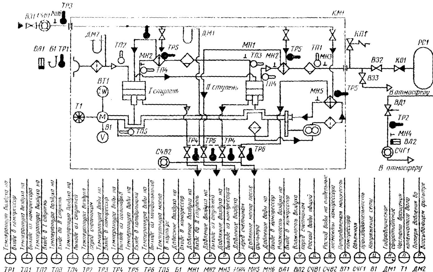
*Б1—барометр; В1—вольтметр; ВД1—дросселирующий вентиль; В31—В33—запорные вентили; ВЛ1; ВЛ2—влагомеры; ВТ1—ваттметр; ДМ1, ДМ2—дифманометры; КМ1—компрессор; КО1—обратный клапан; КП1—предохранительный клапан; МН1—МН6—манометры; РС1—ресивер; СЧВ1, СЧВ2—счетчики воды; СЧГ1—счетчик газа; Т1—тахометр; ТП1—ТП5—термопары; ТР1—ТР6—рутные термометры*
