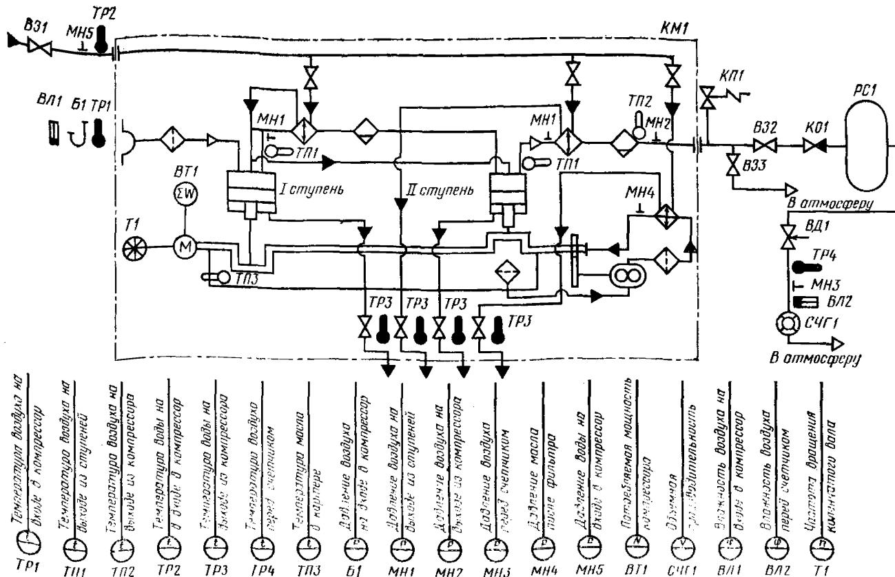
*Б1*—барометр; *ВТ1*—ваттметр; *ВЛ1*, *ВЛ2*—влагомеры; *ВД1*—дросселирующий вентиль; *В31*—*В33*—запорные вентили; *КМ1*—компрессор; *КП1*—предохранительный клапан; *КО1*—обратный клапан; *МН1*—*МН5*—манометры; *РС1*—рессивер; *СЧГ1*—счетчик газа; *Т1*—тахометр; *ТР1*—*ТР4*—ртутные термометры; *ТП1*—*ТП3*—термопары
