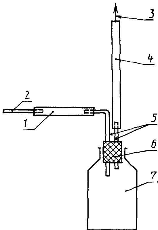
1 — трубка из полиэтилена низкого давления  $d_y = 6$  мм;  $l \approx 600-700$  мм; 2 — острый наконечник для отбора пробы из мешка (титан или нержавеющая сталь  $d_y = 5$  мм,  $l \approx 150$  мм); 3 — к вакуум-насосу; 4 — трубка из полиэтилена низкого давления  $d_y = 6$  мм; 5 — трубка из титана или нержавеющей стали  $d_y = 6$  мм; 6 — пробка резиновая; 7 — бутыль или колба из толстостенного стекла вместимостью 1—2 дм<sup>3</sup>.
