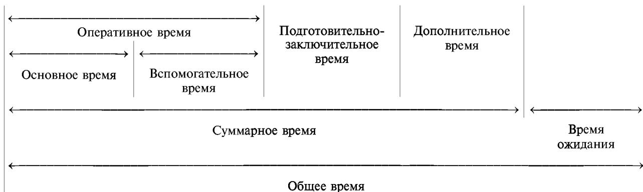
Под подготовительно-заключительным временем технического обслуживания (ремонта) понимается время, затрачиваемое каждым исполнителем на подготовку и приведение в порядок рабочего места и материальных средств перед началом технического обслуживания (ремонта), в процессе выполнения и после его завершения, а также на получение задания, инструктаж и ознакомление с технической документацией.
