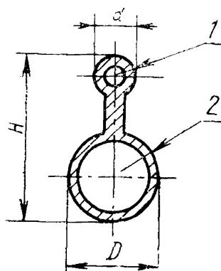
$D$  — диаметр кабеля;  $d$  — диаметр изолированного троса;
