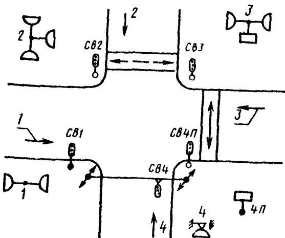
1—4 (на полке-выноске) — направление движения транспортных средств; С81—С84, С84П — обозначение светофорной установки; 1—4 и 4П — обозначение элементов организации дорожного движения светофорных установок С81—С84 и С84П.
