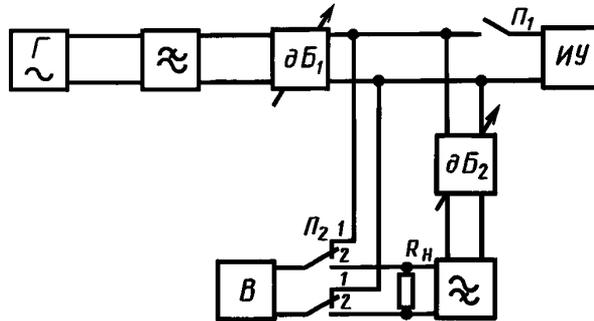
Г — измерительный генератор; ⌘ — фильтр нижних частот; дБ<sub>1</sub>, дБ<sub>2</sub> — магазины затуханий; ⌘ — фильтр верхних частот; В — избирательный измерительный прибор; ИУ — измеритель уровня; П — переключатель; R<sub>н</sub> — нагрузка фильтра
