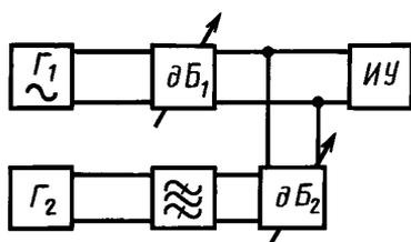
$\Gamma$  — измерительный генератор;  $\partial B$  — магазин затуханий; ИУ — измеритель уровня;  $\approx$  — полосовой фильтр
