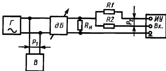
$\Gamma$  — измерительный генератор;  $дБ$  — магазин затуханий;  $B$  — образцовый измерительный прибор;  $R_1, R_2$  — резисторы;  $ИУ$  — измеритель уровня;  $R_n$  — нагрузка магазина затуханий
