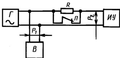
Г — измерительный генератор; R — резистор; П — переключатель; В — образцовый измерительный прибор; ИУ — измеритель уровня
