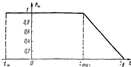
$P_t$  — допускаемая мощность рассеяния при заданной температуре, Вт;  $P_{\text{ном}}$  — номинальная мощность рассеяния, Вт;  $t_n$  — нижнее значение температуры окружающей среды, К ( $^{\circ}\text{C}$ );  $t_{\text{max}}$  — максимальное значение температуры окружающей среды для номинальной мощности рассеяния, К ( $^{\circ}\text{C}$ );  $t_b$  — верхнее значение температуры окружающей среды, К ( $^{\circ}\text{C}$ )
