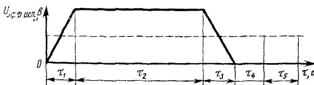
— — — переменное напряжение; — — — постоянное напряжение;  $\tau_1$  — время подачи переменного напряжения 0,2—0,5 с;  $\tau_2$  — время выдержки под суммарным испытательным напряжением (5±2) с;  $\tau_3$  — время снятия переменного напряжения 0,2—0,5 с;  $\tau_4$  — время выдержки под напряжением постоянного тока до момента контроля сопротивления изоляции (2±0,2) с;  $\tau_5$  — время контроля сопротивления изоляционного промежутка.
