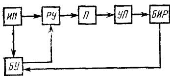
*ИП—источник питания; РУ—регулирующее устройство, осуществляющее установку испытательного напряжения; П—преобразователь (высоковольтный трансформатор); УП—устройство для подключения испытуемого объекта; БИР—блок индикации и регистрации; БУ—блок управления.*
