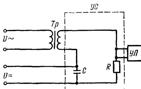
**U<sub>~</sub>**—источник переменного напряжения; **U**=—источник постоянного напряжения; **T<sub>p</sub>**—высоковольтный трансформатор; **R**—ограничительный резистор; **C**—разделительная емкость, 1—5 мкФ; **УС**—устройство совмещения постоянной и переменной составляющих; **УП**—устройство для подключения испытуемого объекта
