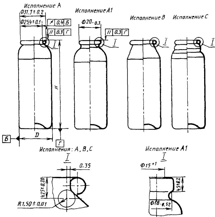
Примечание. Размеры  $R$  ( $1,50 \pm 0,01$ ) и 0,35 не являются контролируемыми и даны для изготовления инструмента.
