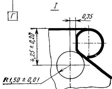
П р и м е ч а н и е. Размеры  $R(1,50 \pm 0,01)$  и 0,35 не являются контролируемыми и даны для изготовления инструмента.
