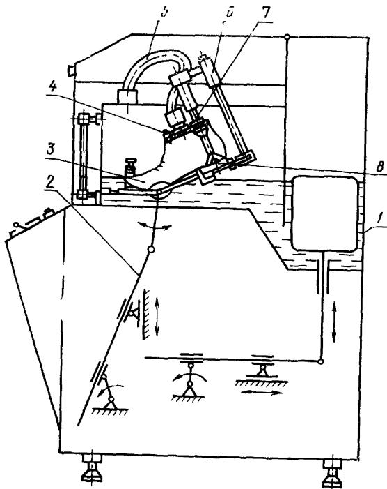
колодка вместе с обувью прижимается к подвижной плите 8, ниппель 4 и пучок проводов с разъемом 5. С помощью соединительных кабелей контактная колодка подключается к сигнальной установке. Контакты из токопроводящей резины, размещенные в определенных участках поверхности колодки, с сигнальным устройством обеспечивают испытание водостойкости различных участков обуви.
