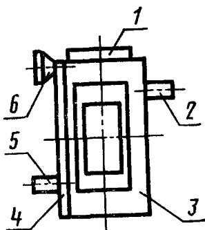
1—указатель частоты вращения; 2, 5—входной или выходной валы; 3—корпус; 4—крышка; 6—маховик.
