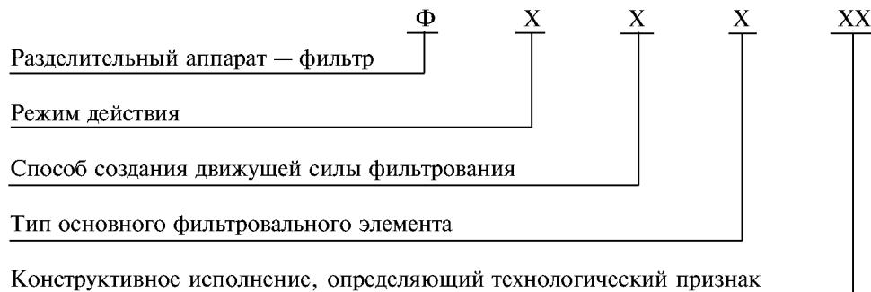
Пример обозначения фильтра периодического действия под давлением листового вертикального сухой выгрузкой:
