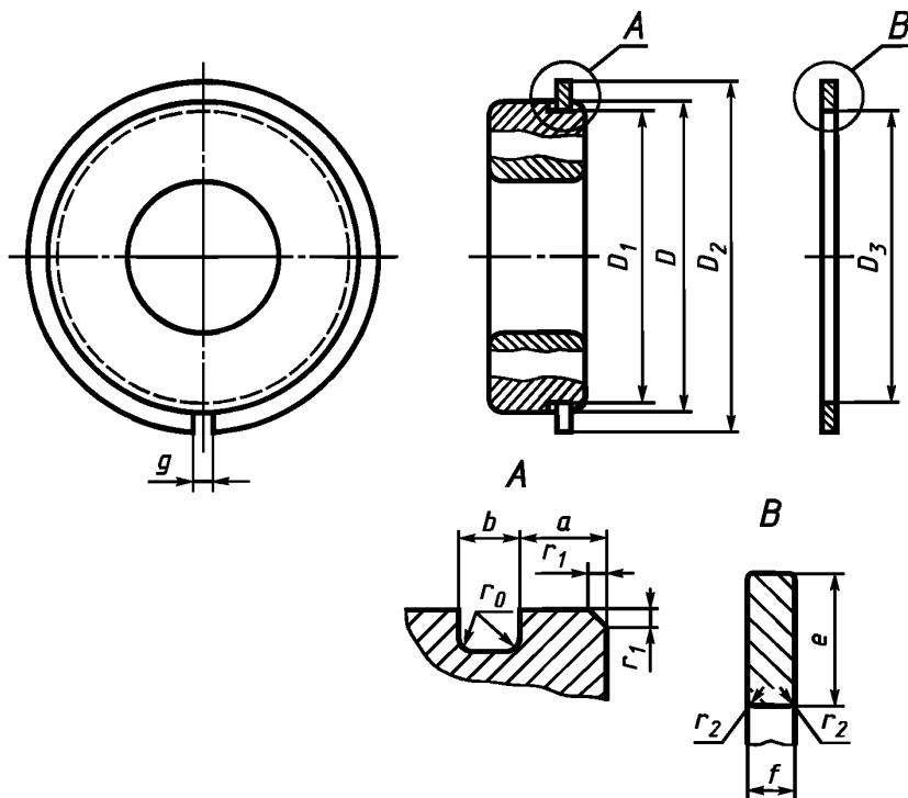
П р и м е ч а н и е. Чертеж не определяет конструкцию упорного пружинного кольца.
