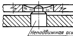
**3.2. Камни без отверстий, служащие в качестве осевых опор**
