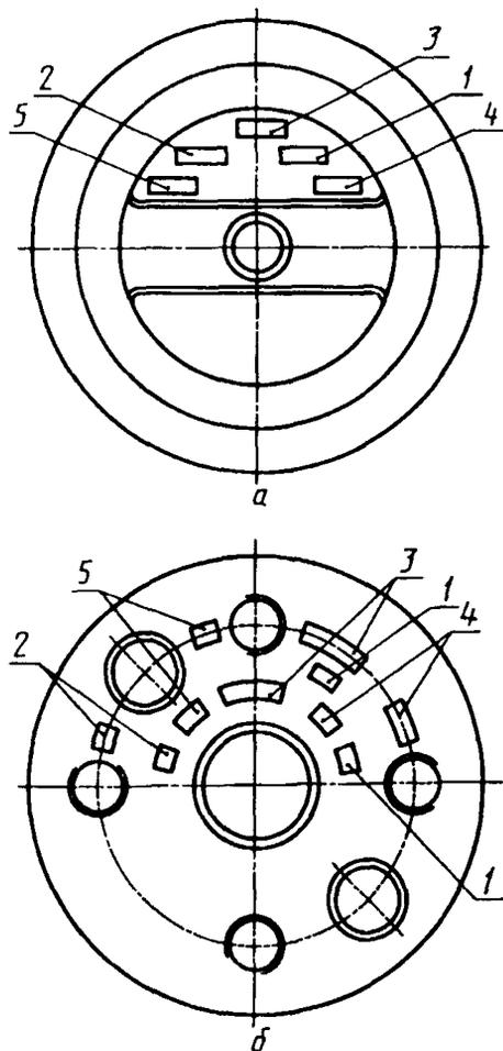
1 — приемочные клейма; 2 — условный номер предприятия, производившего обработку и перенесшего знаки маркировки; 3 — номер оси; 4 — две последние цифры года изготовления черновой оси; 5 — клеймо технического контроля
