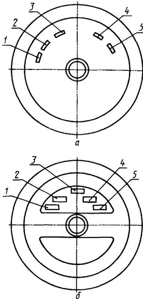
1 — условный номер предприятия-изготовителя черновой оси; 2 — месяц (римскими цифрами) и две последние цифры года изготовления черновой оси; 3 — номер оси; 4 — клейма технического контроля предприятия-изготовителя и инспектора-приемщика, принявших чистовую ось; 5 — условный номер предприятия-изготовителя, обработавшего черновую ось
