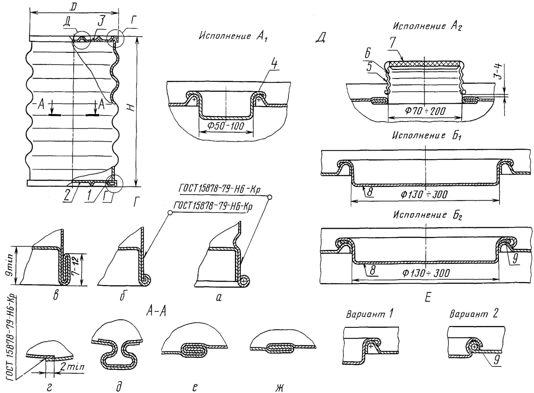
1 — обечайка; 2 — нижнее днище; 3 — верхнее несъемное днище (верхние съемные днища барабанов исполнений  $B_1, B_2, B_3, B_4$  — черт.2); 4 — капсюль; 5 — навинчивающаяся крышка; 6 — горловина; 7 — прокладка; 8 — крышка лючка; 9 — прокладка
