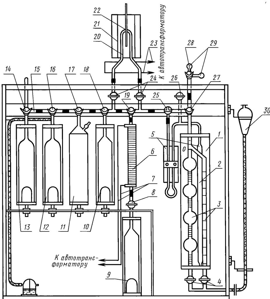
2.1.2. Перед сборкой все стеклянные части прибора тщательно промывают водой. Бюретку 3 и компенсатор давления 5 с компенсационной трубкой 2 дополнительно промывают хромовой смесью или ацетоном, которые затем тщательно смывают водой. На вымытой внутренней поверхности бюретки и компенсатора давления не должны задерживаться капли воды.
