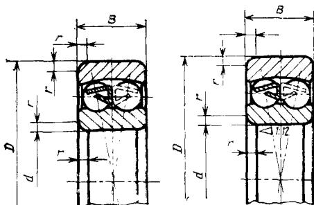
*d — номинальный диаметр отверстия внутреннего кольца; D — номинальный диаметр цилиндрической поверхности наружного кольца; B — номинальная ширина подшипника; r — номинальная координата монтажной фаски.*
