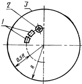
1—образцы для испытаний на ударную вязкость; 2—образцы для испытаний на растяжение; 3—поверхность необработанной оси
