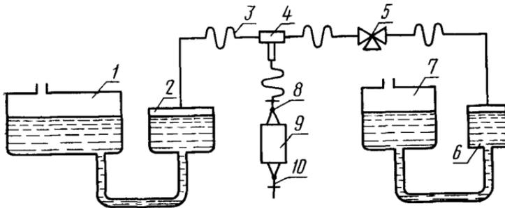
1, 2—подвижный и неподвижный сосуды рабочего эталона; 3—резиновые трубки; 4—тройник; 5—пробковый трехходовой кран; 6, 7—неподвижный и подвижный сосуды поверяемого микроманометра; 8—сильфонный пресс с кранами 8, 10
