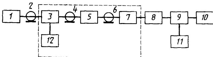
1—измерительный генератор; 2, 4, 6—коаксиальный кабель; 3—коаксиальный переключатель; 5—фильтр; 7—согласующее устройство; 8—коаксиальный соединитель; 9—образцовый делитель напряжения; 10—поверяемый вольтметр; 11—образцовый вольтметр; 12—нагрузочный резистор
