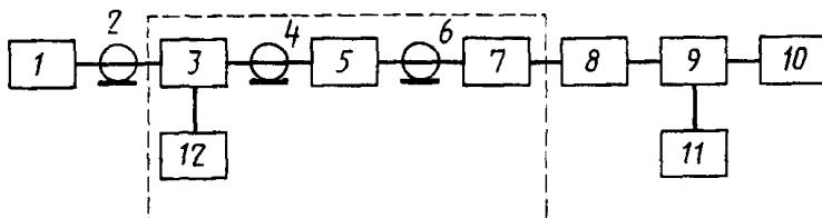
1—измерительный генератор; 2, 4, 6—коаксиальный кабель; 3—коаксиальный переключатель; 5—фильтр; 7—согласующее устройство; 8—коаксиальный соединитель; 9—коаксиальный измерительный соединитель-тройник (например элемент № 11—1 из комплекта вольтметра типа В3—24); 10—поверяемый вольтметр; 11—образцовый вольтметр; 12—нагрузочный резистор
