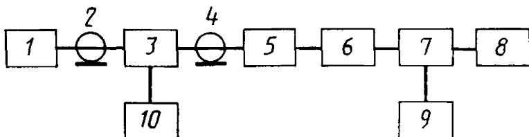
**1**—измерительный генератор, **2**, **4**—коаксиальный ка-
