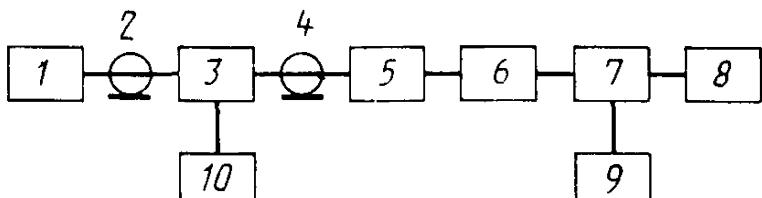
**1**—измерительный генератор, **2**, **4**—коаксиальный ка-
