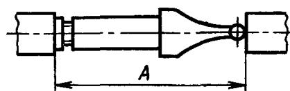
Размер  $A$  следует определять микрометром.
