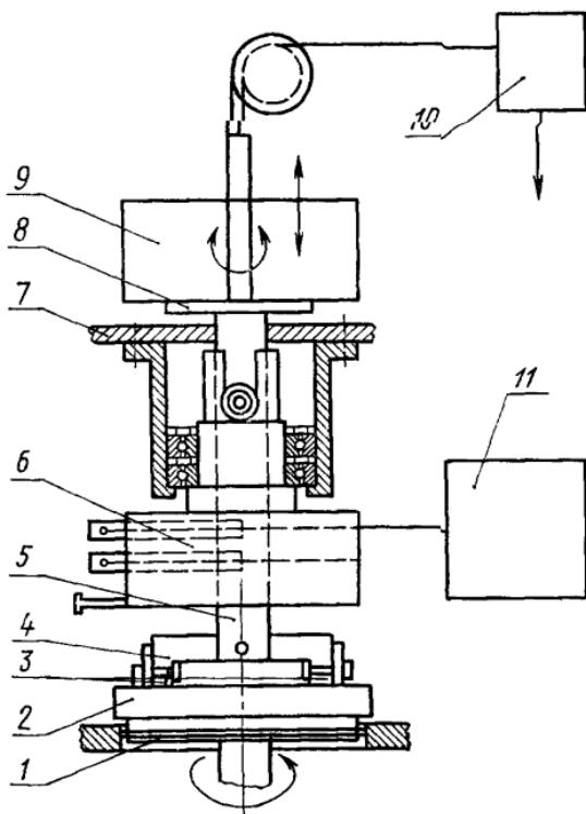
Узел истирания состоит из сменной платформы 2 для закрепления образца, истирателей 3 и динамометра 11 для измерения силы трения или слизания.
