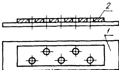
а — испытание основного металла
