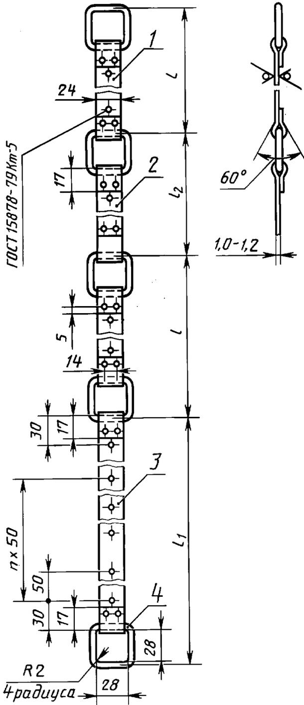
1 — лента боковой стенки, 2 шт.; 2 — лента дна, 1 шт., 3 — лента крышки, 1 шт.; 4 — серьга, 5 шт.; проволока диаметром 4 мм;  $l$  — ширина боковой стенки плюс толщина дощечек дна и крышки;  $l_1$  — ширина крышки минус 150 мм;  $l_2$  — ширина дна плюс 6 мм
