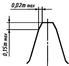
1. При изготовлении зубчатых колес допускается срез или закругление кромок вершин зубьев по высоте не более  $0,15 m$  и глубине не более  $0,02 m$  (см. чертеж).
