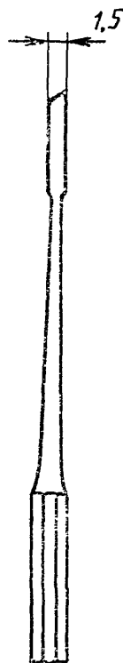
Рисунок 13 — Прямое долото со скошенным лезвием, правое
