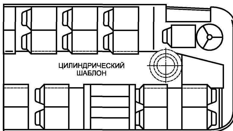
Рисунок 3.14 (см. 5.7.5.3.3) — Сиденья установлены против направления движения
