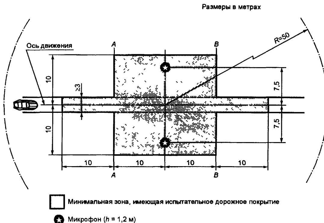
Рисунок 1 — Минимальные требования в отношении зоны с испытательным покрытием Затемненная часть называется испытательной зоной
