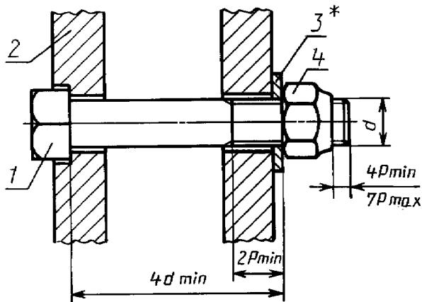
\* Провертывание шайбы не допускается.
