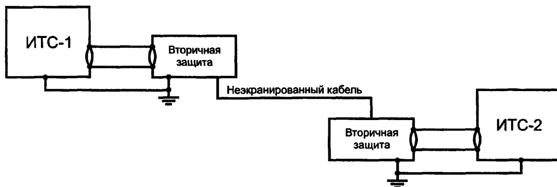
Рисунок Б.1 — Схема защиты с использованием экранированного кабеля в зданиях с общей системой заземления
