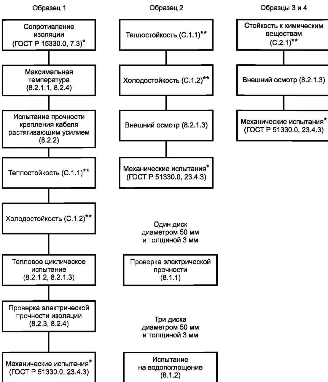
\* За исключением приборов и элементов, достаточно хорошо запищенных от воздействия окружающей среды. В случае, если данное испытание не проводилось, прибор должен иметь маркировку X, а в сопроводительной документации должны быть указаны ограничения по использованию.
