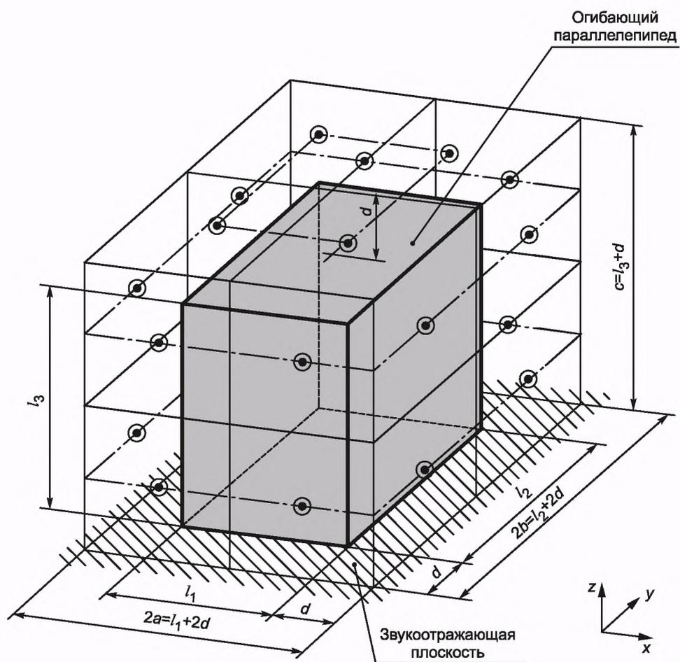
Рисунок В.5 — Пример измерительной поверхности и точек измерения на ней для машин среднего размера ( $d < l_1 \leq 4d, d < l_2 \leq 4d, 2d < l_3 \leq 5d$ )
