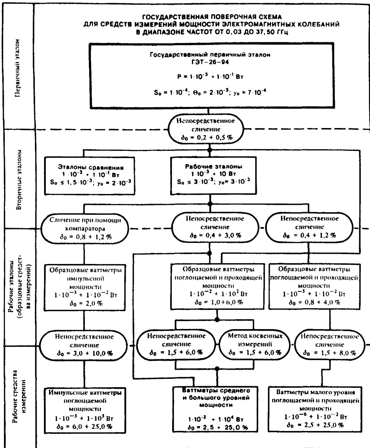
Ключевые слова: государственная поверочная схема, средства измерения, эталон, мощность электромагнитных колебаний, ваттметр, погрешность
