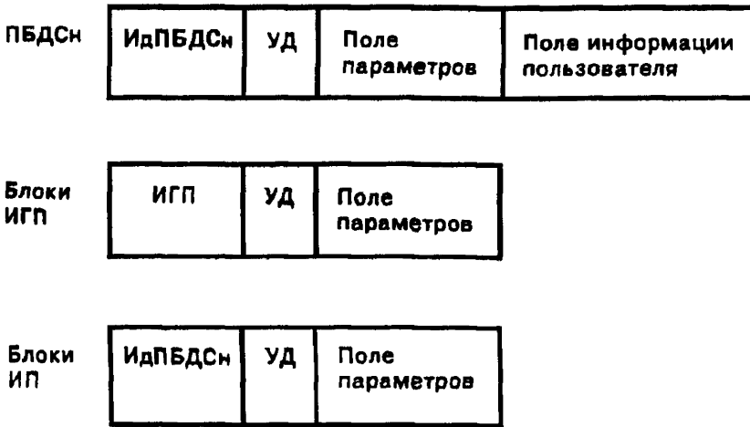
Рисунок 5 — Иллюстрация структуры ПБДСн и блоков ИГП и ИП
