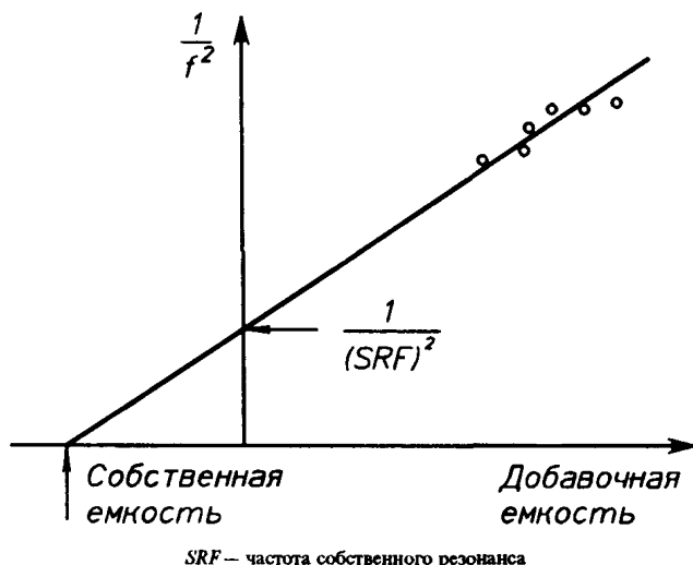
Рисунок 9 — Типичный график для определения собственной емкости
