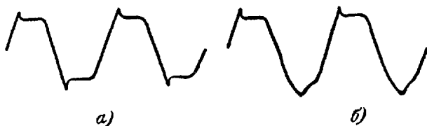
Рис. 3-11. Форма кривой напряжения манипуляции. а — при правильном сочетании полярностей стабилизаторов напряжения 2СТ1 и 2СТ2; б — при неправильном сочетании полярностей 2СТ1 и 2СТ2.
