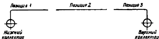
Рис. 2. Раскладка экранных труб перед стыковкой
