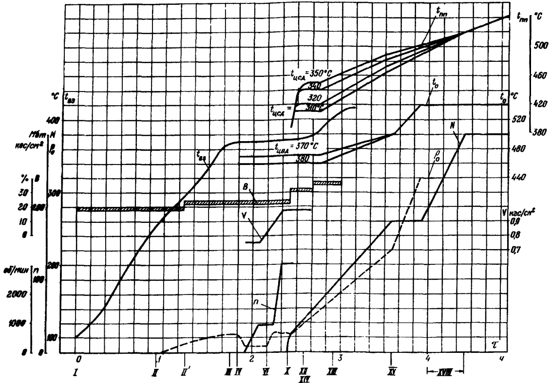
Рис. 6. График-задание пуска блока из неостывшего состояния (температура паровпуска ЦВД 370-380°C, температура паровпуска ЦСД 310-350°C, продолжительность простоя 24-30 ч)
