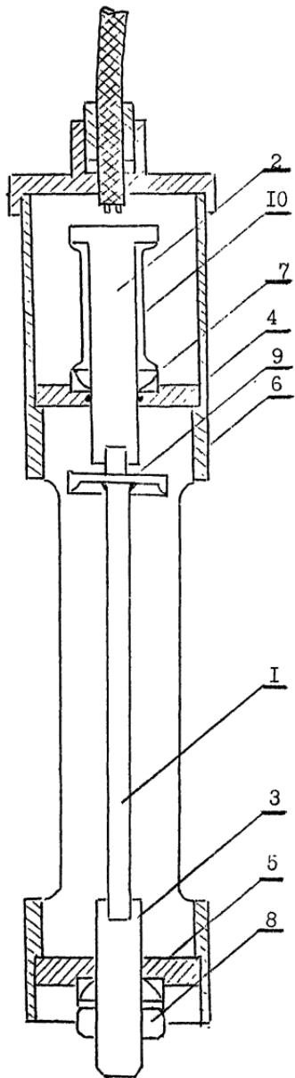
Рис. Схема датчика коррозии
