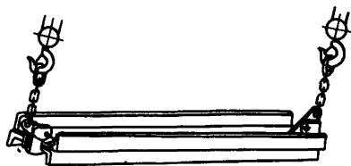
Рис.5. Строповка швеллера захватами
