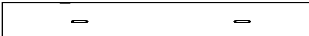
Пример 2 — две несплошности длиной по 6,4 мм
