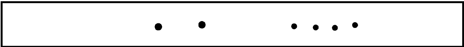
Пример 5 — две несплошности диаметром по 1,6 мм; четыре — по 0,8 мм
