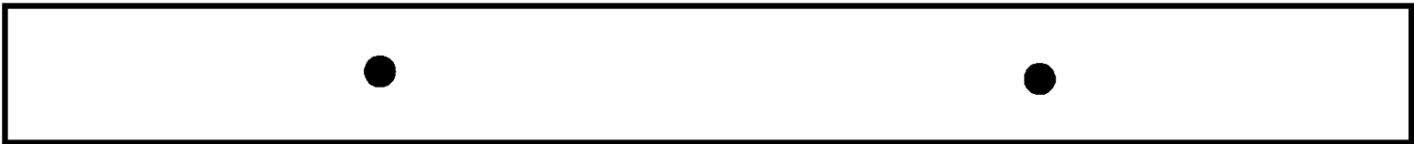
Пример 1 — две несплошности диаметром по 3,2 мм
