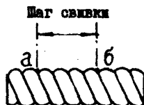
Рис. П7.1. Схема определения шага свивки шестипрядного каната
