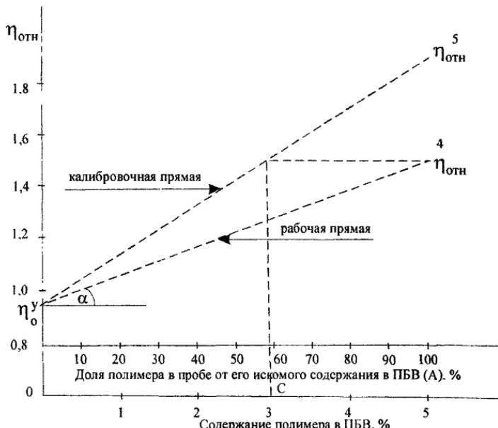
**Зависимость относительной вязкости 18,7% раствора ПБВ в толуоле от содержания полимера**
