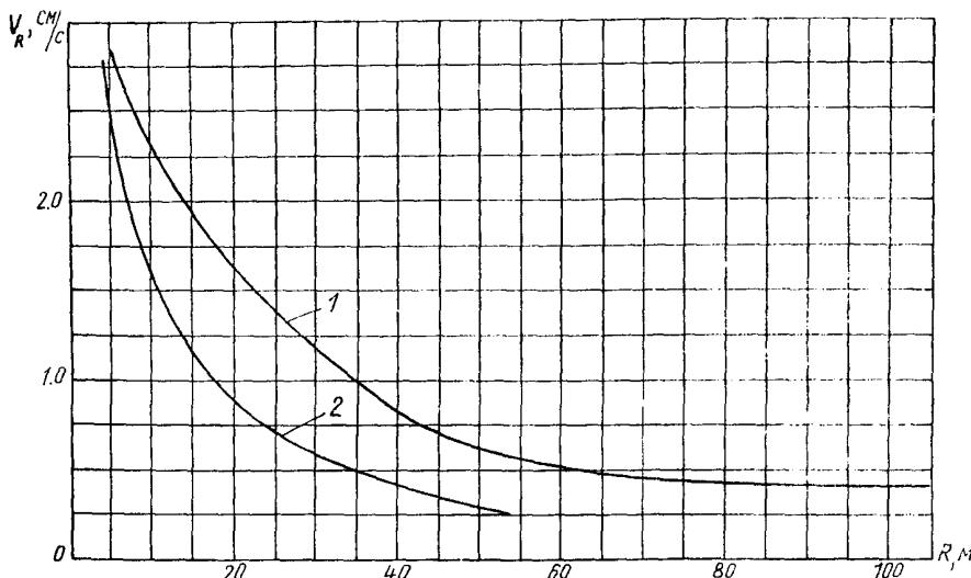
Зависимости максимальных амплитуд выброскорости колебаний поверхности грунта  $V_R$  от расстояния  $R$  до погружаемых свай или шпунта: 1 - при погружении свай вибропогружателями мощностью 60-200 кВт при частоте 5-9 Гц; 2 - при погружении свай или шпунта вибропогружателями мощностью до 60 кВт при частоте 5-25 Гц
