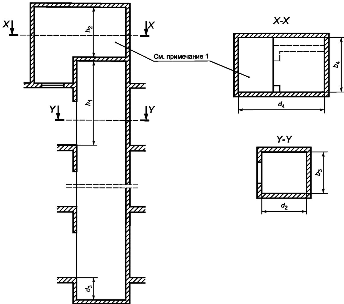
$b_3$  — ширина шахты;  $b_4$  — ширина машинного помещения;  $d_2$  — глубина шахты;  $d_3$  — глубина приямка;  $d_4$  — глубина машинного помещения;  $h_1$  — высота шахты от уровня верхней посадочной площадки до выступающих частей перекрытия над шахтой;  $h_2$  — высота машинного помещения
