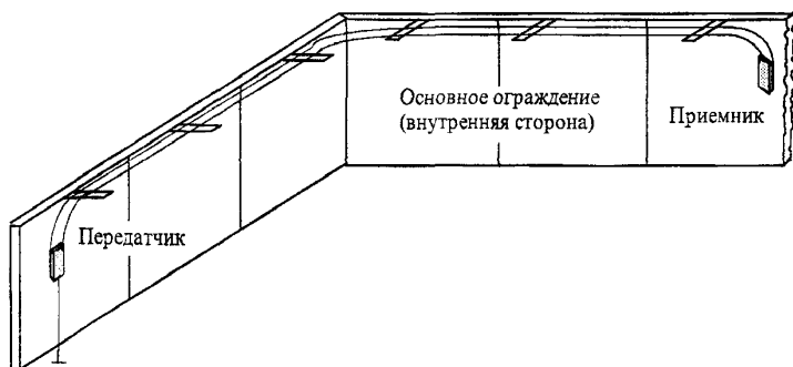
Рисунок 5 - Вариант блокировки "козырька" основного ограждения извещателем "Уран-1М"
