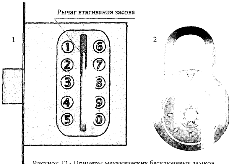
Рисунок 12 - Примеры механических бесключевых замков 1 - врезной замок с кнопочным кодонабирателем; 2 - висячий замок с дисковым кодонабирателем
