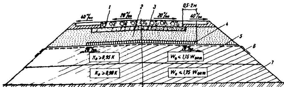
Конструкции дорожной одежды и земляного полотна при использовании грунтов повышенной влажности в пределах рабочего слоя: 1 – цементобетонное покрытие толщиной 20–24 см; 2 – слой песка (25–30 см), укрепленный в верхней части цементом (3); 4 – теплоизолирующий слой из пенопласта (5–10 см); 5 – прослойка из геотекстильного материала (0,15–0,30 см); 6 – верхний слой (50 см) земляного полотна; 7 – нижний слой земляного полотна
